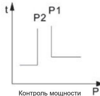
Порог включения P1  $\geq$  порога отключения P2
