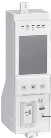
Нажмите кнопку TEST, чтобы смоделировать аварийное срабатывание выключателя
