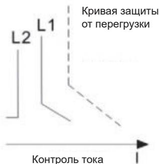
Порог включения L1  $\geq$  порога отключения L2
